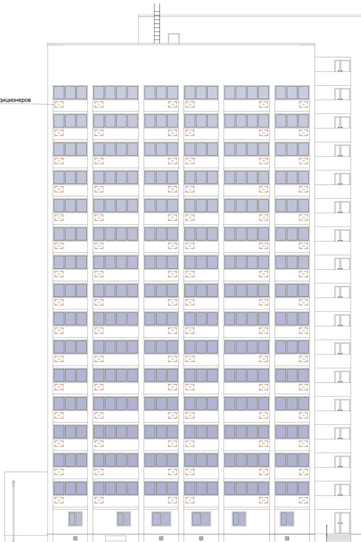
6. Места возможного размещения наружных блоков кондиционеров
