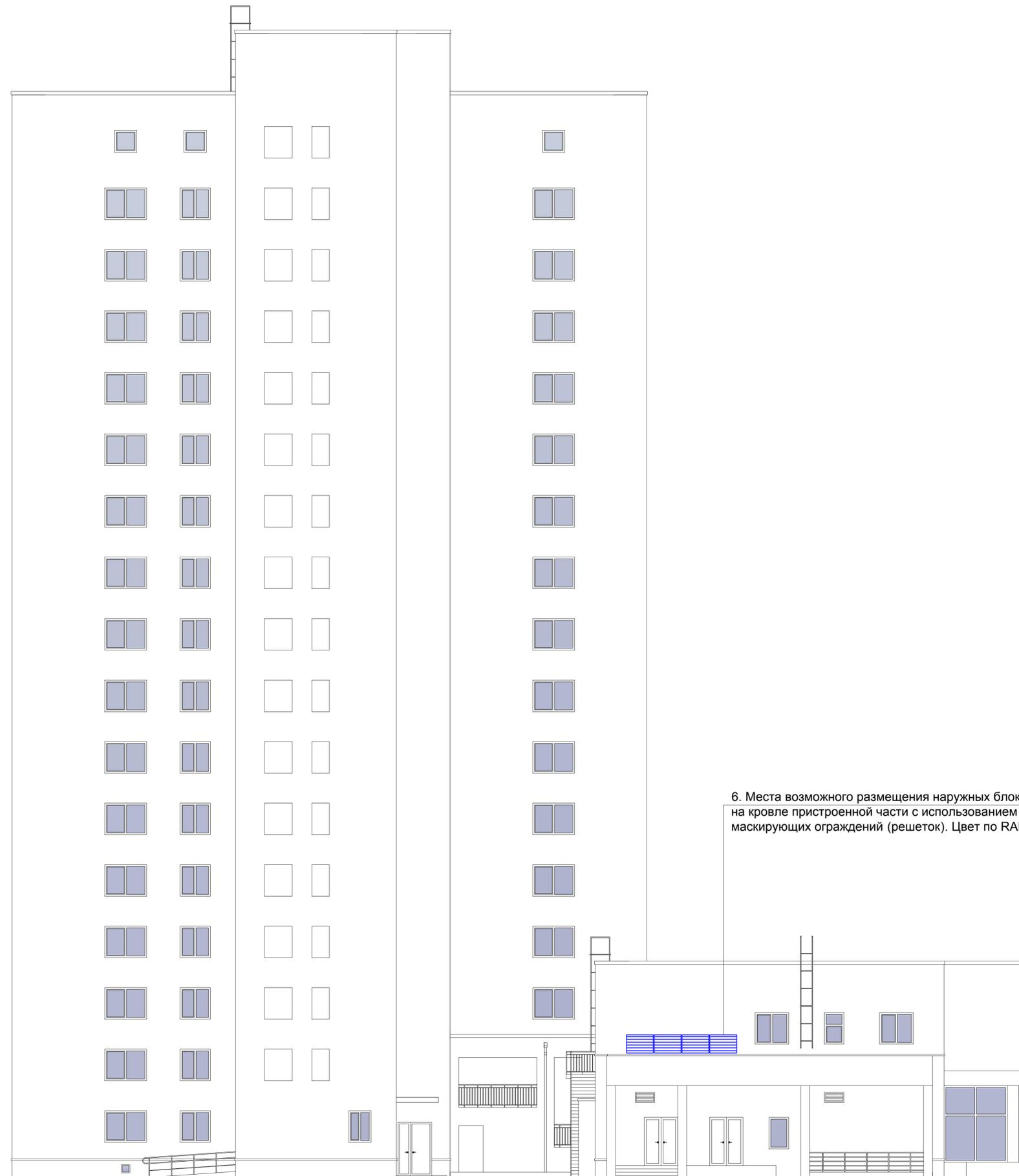
6. Места возможного размещения наружных блоков кондиционеров на кровле пристроенной части с использованием маскирующих ограждений (решеток). Цвет по RAL 3012
