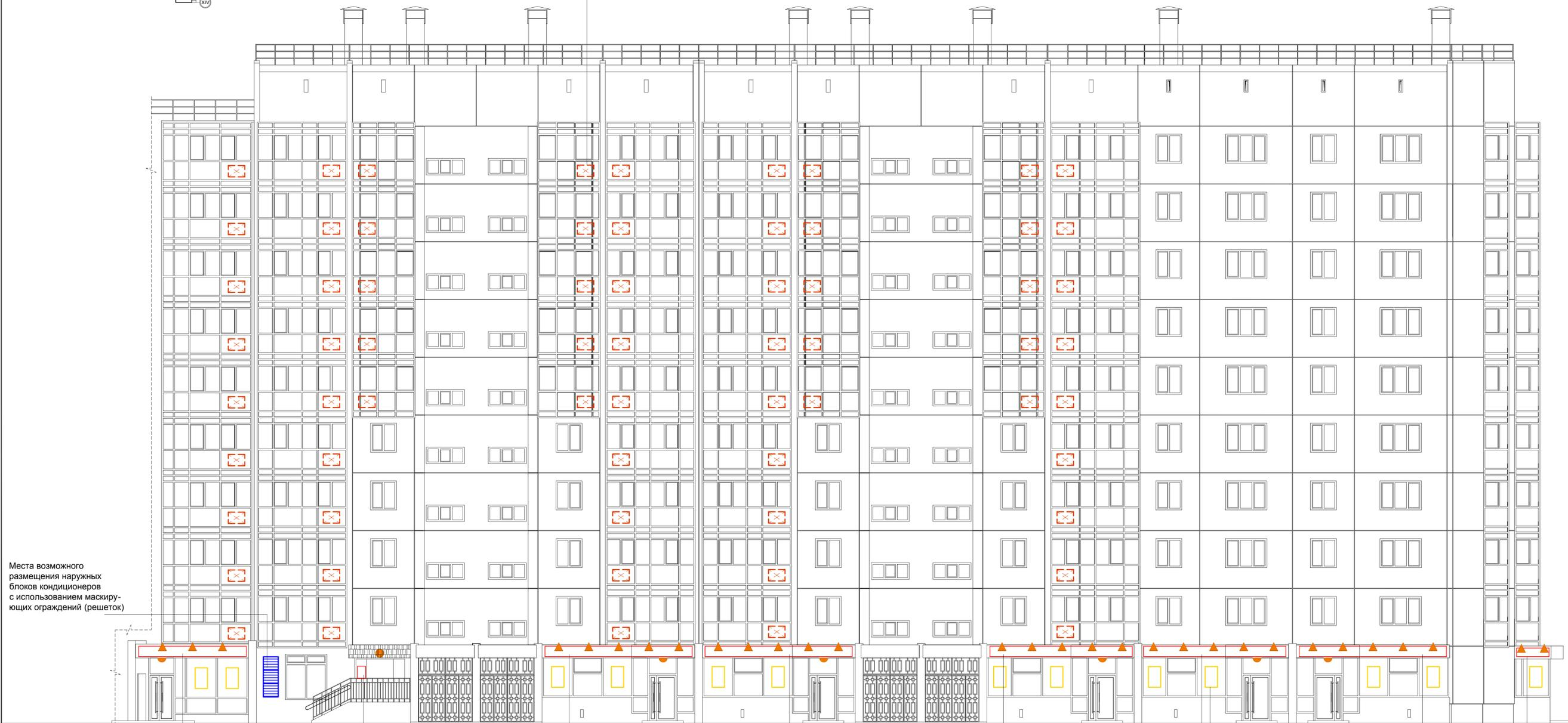
Места возможного размещения наружных блоков кондиционеров с использованием маскирующих ограждений (решеток)
